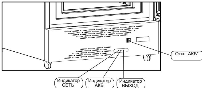
**Примечание** \*«Откл. АКБ» - отключение аккумулятора от цепи (использовать при длительном простое)
