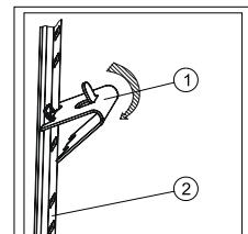
**Установка полок** В камере, полки устанавливаются на упоры.
